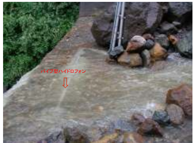
図2: 白水谷 (京都大学穂高砂防観測所) 設置のパイプ型ハイドロフォン
